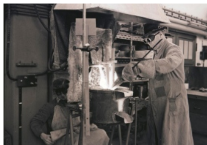
Die Gesellschaft für Elektrometallurgie in Nürnberg konnte erstmals nach jahrelangen geheimen Versuchen das metallische Element Vanadium mit einem Reinheitsgrad von 99,9 v.H. praktisch gasfrei herstellen. Das Metall wird u.a. von den Amerikanern für Weltraum-Raketen verwendet. Hier: Im Elektro-Schmelzofen wird in sehr großer Hitze ein Vorprodukt des V-Metalls gewonnen. © NN
