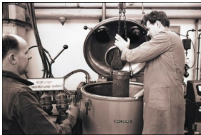
Aus einem modernen Vakuum-Ofen holt ein Arbeiter entgastetes, hochreines Vanadium heraus. © NN
